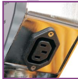
外輸電源插槽
